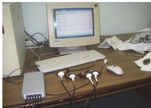
Рис. 2. 6-канальная установка для лабораторных и полевых исследований реакций моллюсков
