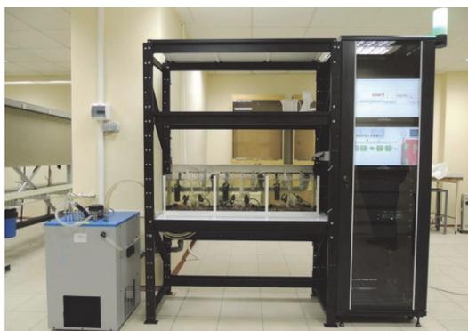
Рис. 1. Установка для автоматического контроля качества забираемой воды на Рублевской станции Москва
