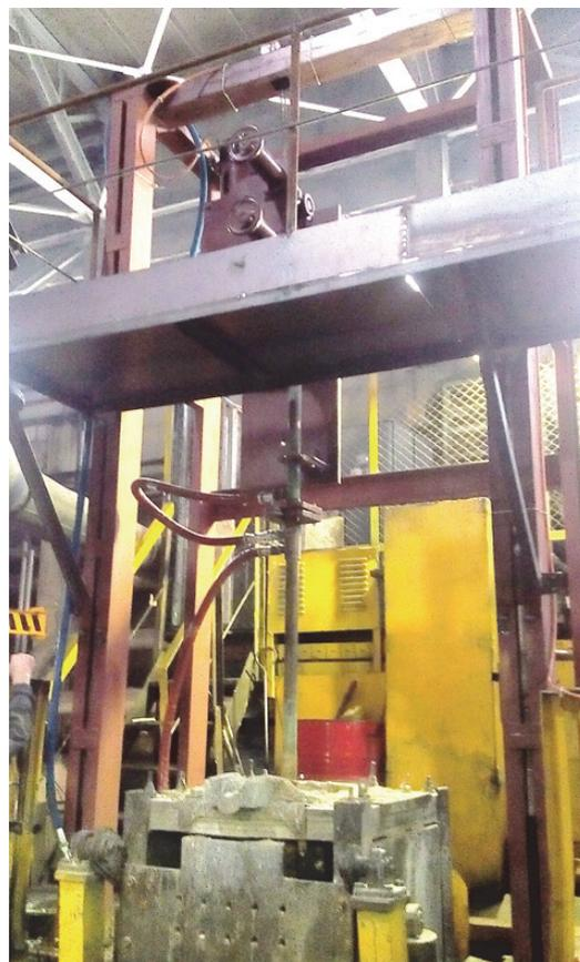
Рис. 2. Установка непрерывного литья вверх на КУЗОЦМ
